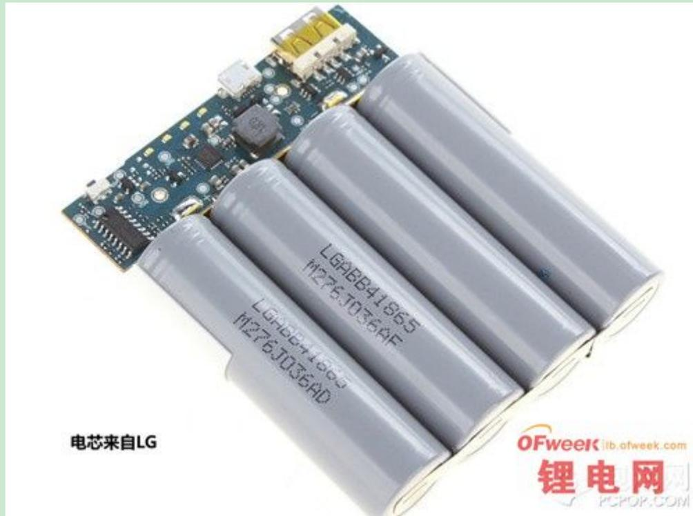
小米 10400 移动电源内部结构
