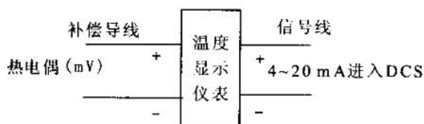
图3 热电偶与温度显示表、DCS接线图
