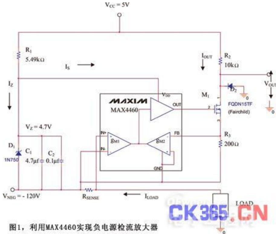
图 1，利用MAX4460实现负电源检流放大器
