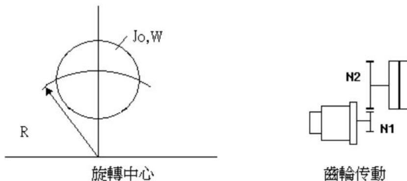
属于这种情况的例子; 如大直径的齿轮, 为了减少惯量, 往往在圆盘上挖出分布均匀的孔这时的惯量可以这样计算;
