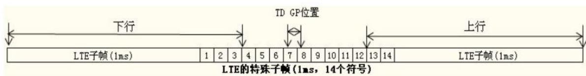
图 5 常规 CP 配置 5 中 TD-LTE 特殊子帧和 TD GP 的相对位置关系
