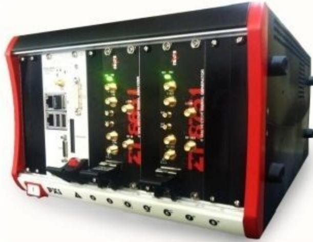
图 8: z8201 PXI 或 PXIe RF 测试套件。
