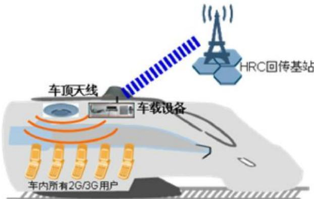
解决重叠区对切换和重选的需求：LTE 扁平化的网络架构和精简的信令流程，保证切换可在几百毫秒内完成，远小于 GSM 的 5~6S，大大降低切换区设计难度。
