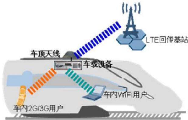
消除频繁的群切换问题：高铁旅客进入车厢后，即通过车厢内 2G/3G 网络接入，在列车运行过程中，2G/3G 没有小区间切换问题，更不存在群移动导致的信令风暴问题。
