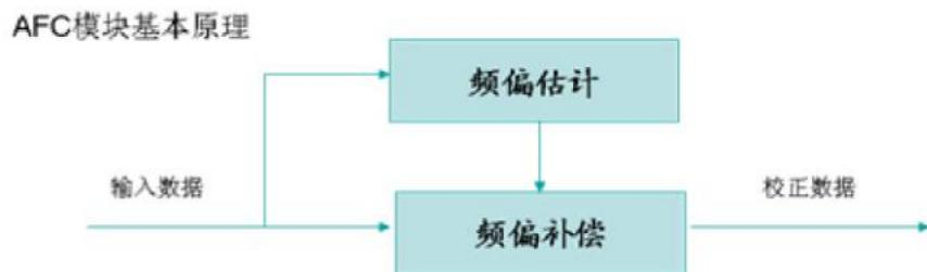
F-AFC 功能通过频偏估计模块估计频偏，将估计出的频偏对输入的数据进行频偏补偿，达到纠正多普勒频偏的效果。对于 HRC 车载台 TAU 来说，其基于华为第四代基站平台开发，更易于应用更先进的频偏纠正算法。
