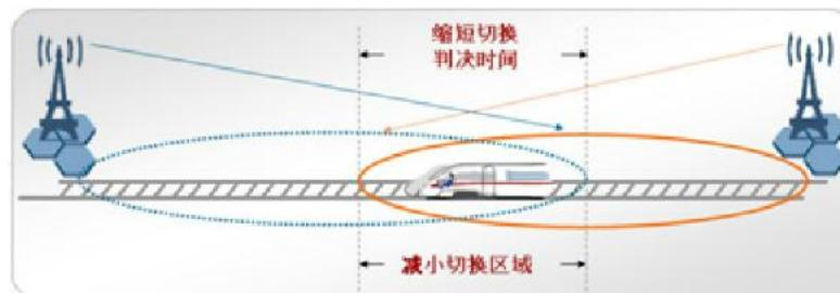
克服多普勒效应：应用了经 430Km/h 磁悬浮验证的华为特有的 F-AFC 算法、快速切换算法，消除高速对列车
