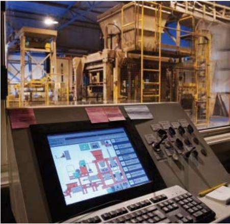
人机界面(HMI)，也称为用户界面、操作面板或终端，提供了一种控制、监视、管理和/或显示设备流程的一种手段。操作面板作为一个样例，能够使工业机器操作员以一种图形化、可视化的方式与机器进行交互。通过以图形化的方式显示在屏幕上的控制及读数，操作员就能够使用外部按钮或触摸屏来控制机器。HMI的范围从简单的分段显示器到高清晰度的液晶面板，可被安置在机器、电池供电的便携式手持设备上，或是中央控制室中。它们用于机器与过程控制，将传感器、执行器及位于工厂车间的机器与I/O控制及PLC应用系统连接了起来。
