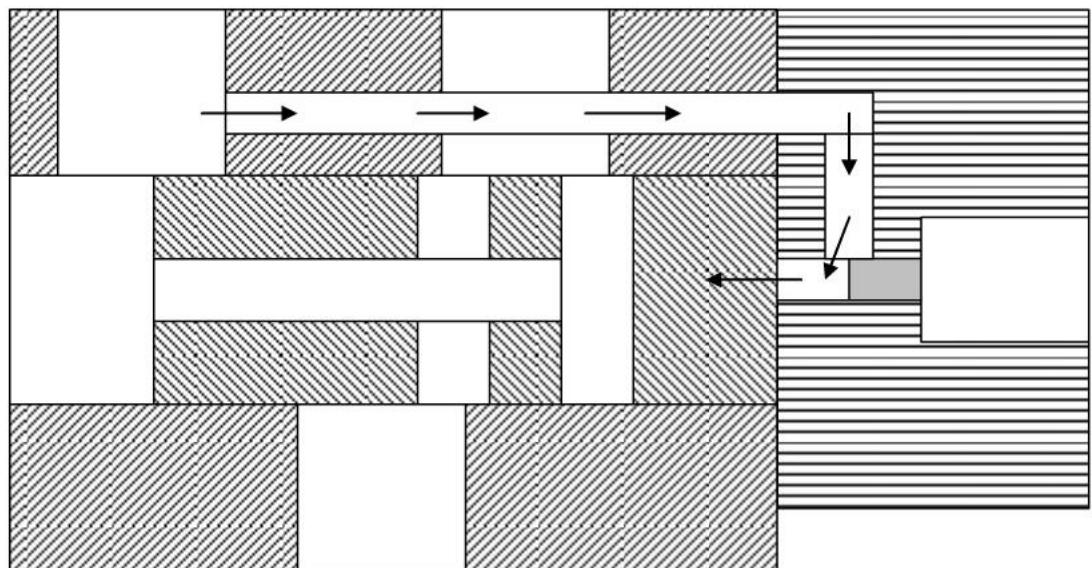
如图：A—小阀芯；B—气管；C—电磁阀铁芯；D—进气口；E—阀芯；
