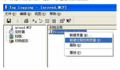
b) 弹出"过程控制变量属性"对话框,点击"选择"按钮来选择"原始数据变量": ARSend; "转化 DLL" 在下拉菜单中选为"nrms7pmc.nll",
