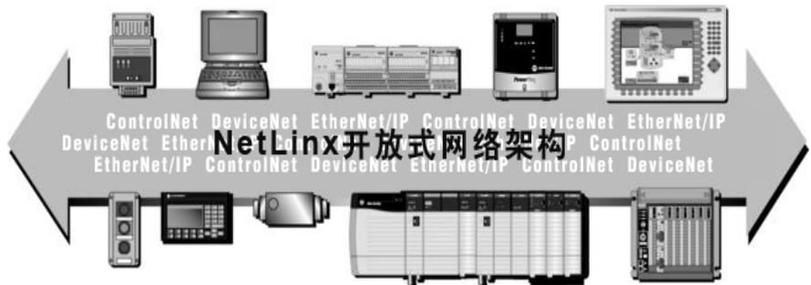
所有基于 NetLinx 的网络 - DeviceNet、ControlNet 和 EtherNet/IP 使用通用工业协议 (CIP)，所以它们使用统一的语言，共享一组相同的通讯服务。
