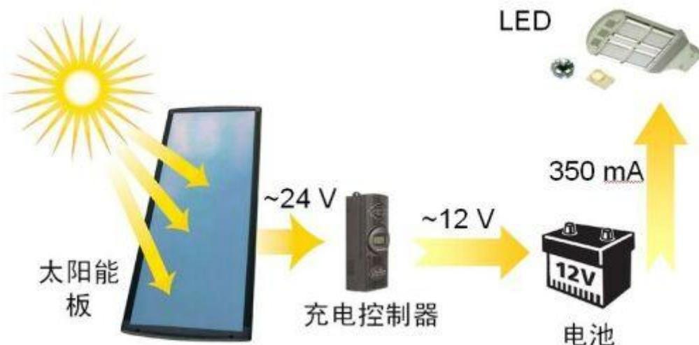
图 1: 典型的太阳能供电街道照明系统示意图
