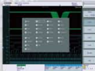
波形参数查找 频率、振幅等测量数据超过指定参数范围时，显示相应波形。
