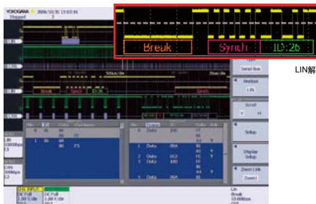
CAN, LIN两个总线信号同时分析、波形 (解码) 显示实例
