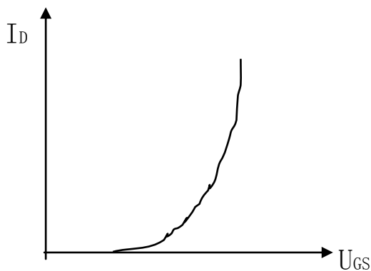
图 1-4: MOSFET 的转移特性
