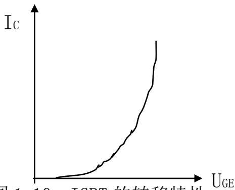
图 1-10: IGBT 的转移特性
