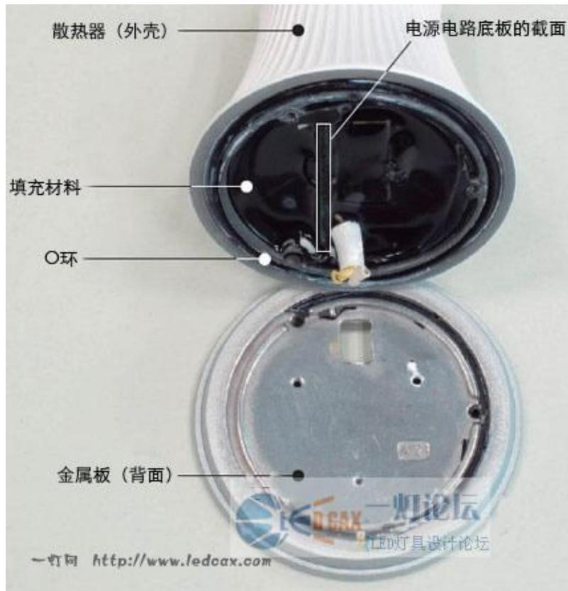
图5：夏普 LED 灯泡的内部金属板利用 3 颗螺丝固定在散热器（外壳）上。散热器内部充满了填充材料，但是与金属板背面不接触，热量只能通过金属板与散热器的接触部分传导。另外，二者之间配置有 O 环，确保了气密性
