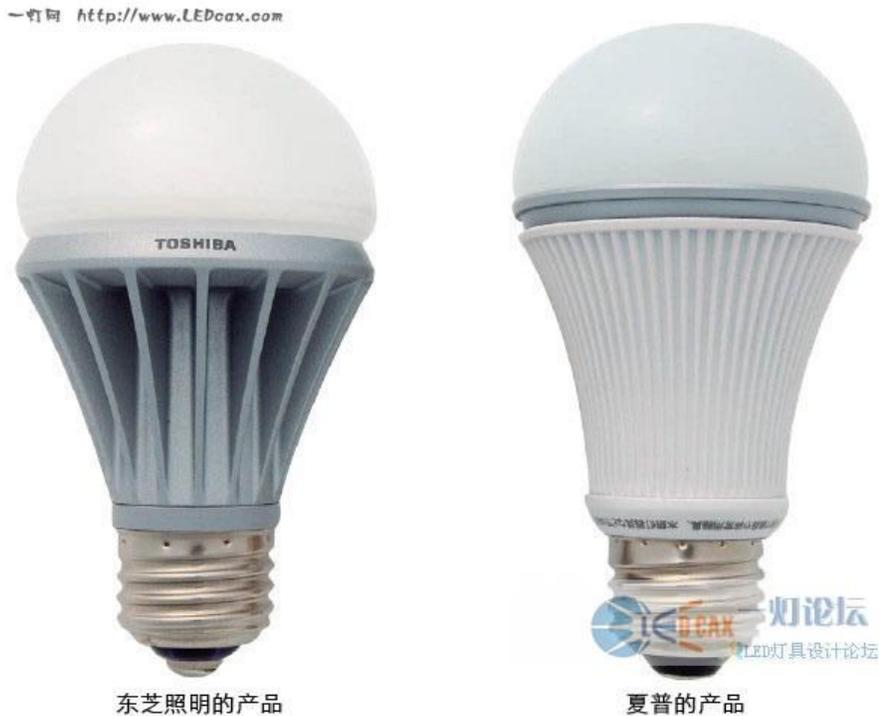
图1：低价LED灯泡东芝照明与夏普陆续上市了价格约为以往一半，即零售价不到4000日元的普通灯泡型LED照明（LED灯泡）。为了防止发光效率下降、寿命缩短，LED的散热非常重要。因此，LED灯泡的下半部分为铝合金铸件制造的散热器。
