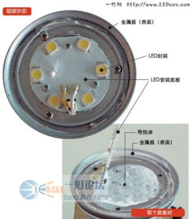
图 4：夏普 LED 灯泡的上部 LED 基片利用 3 颗螺丝固定在金属板上，二者之间涂有导热油。另外，与电源电路底板的布线进行了焊接
