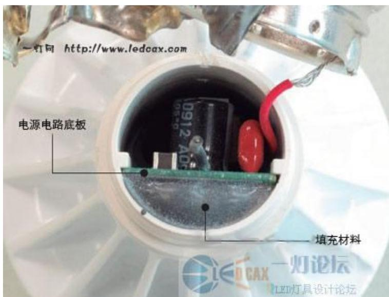
图 11：东芝 LED 灯泡（原有产品）的下部为了使电源电路底板的热量高效传导至散热器，底板背面与散热器充满了填充料。从散热器中拔出树脂壳可以看到，原有产品的树脂壳长度短于新产品（图 12）。而且，树脂壳的侧面还有新产品中没有的开放部位。其目的是使壳中的填充材料与散热器相接触。
