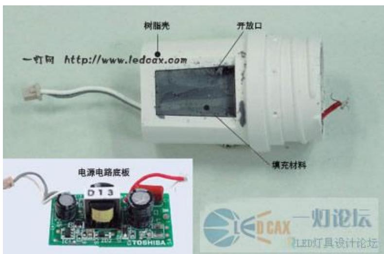
图 12：东芝照明 LED 灯泡（原有产品）的树脂壳与电源电路底板树脂壳上有开放部位，可供填充材料与散热器的内面接触。
