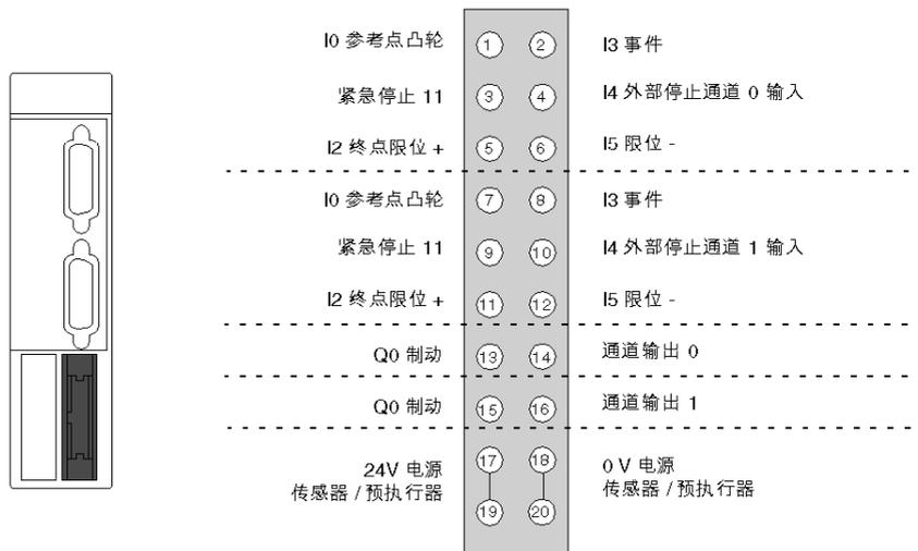
传感器 / 预执行器的 0 V 应在模块中通过 R/C 网络（其值如下）连接到保护性地线： $R = 100$  兆欧 /  $C = 4.7$  nF。
