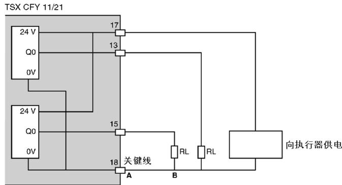
如果电源中断发生在 A 点和 B 点之间，则可能使 RL 执行器无法正常运行。如果可能，应尽量将 0 V 电源双重连接到模块。
