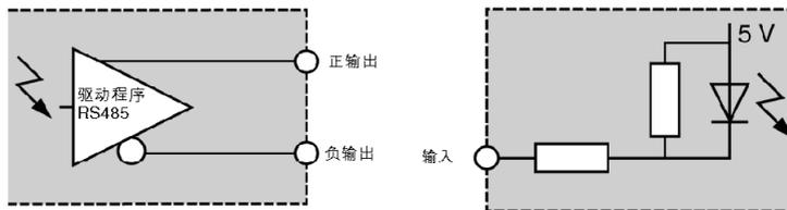
建议的连接类型为：用焊接到连接器上的方式直接进行接线。TSX CAP S15 (参见第 62 页) 套件包含 SUB-D 连接器及其保护盖。
