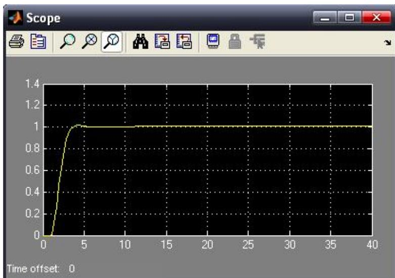
图 5: 模糊自适应 PID 控制系统响应曲线
