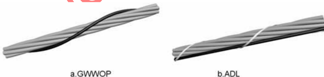
图 1. GWWOP 和 ADL 光缆安装示意图
