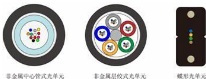
图 9 OPLC 典型光单元结构示意图
