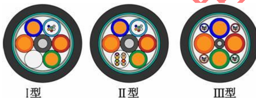
图 7 接入网用光电混合缆结构图
