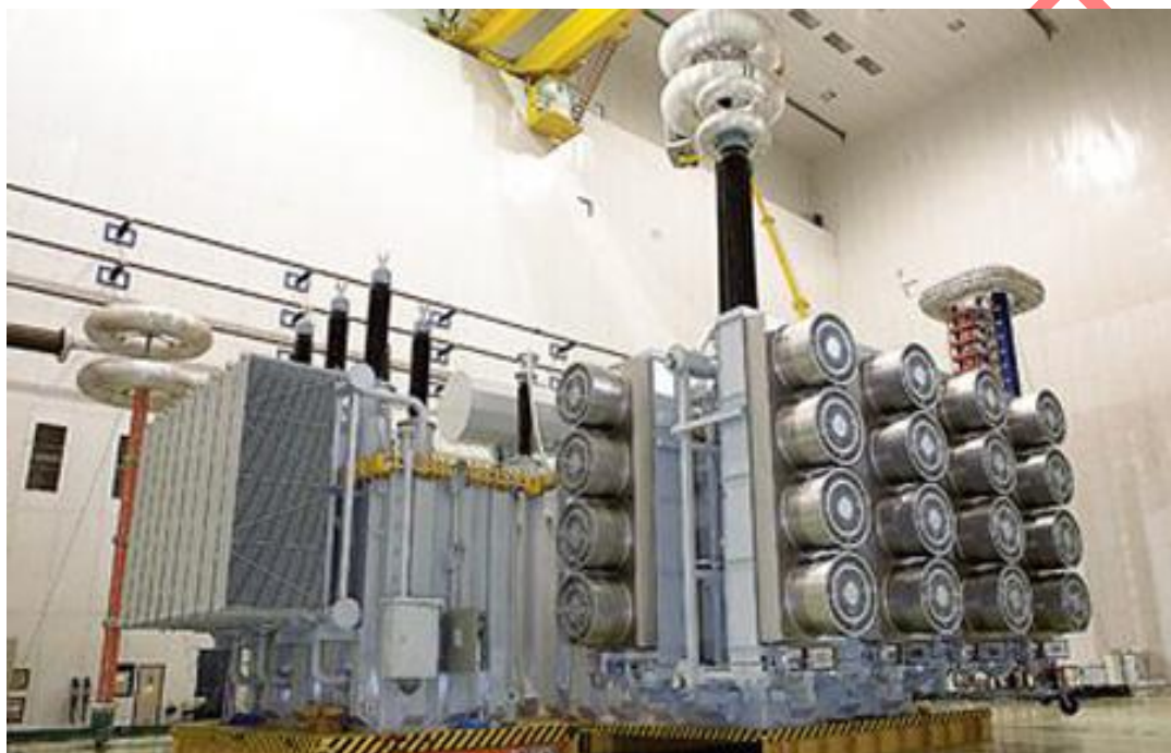
2010年9月，研制成功世界首台1000kV1000MVA双柱结构特高压自耦变压器
