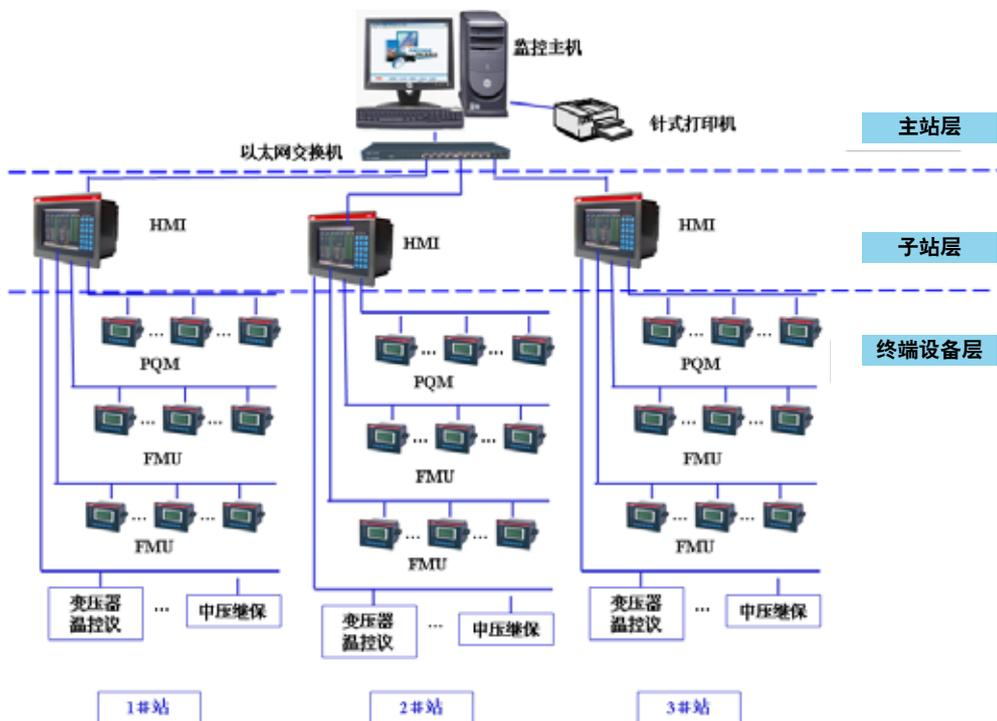
**主站层**监控系统采用模块化的设计理念，各功能管理模块（如柜图监控环境、图形监控环境、动态趋势环境、告警查询、动态报表、逻辑关系、负荷管理等）均可独立运行于不同的工作站上，也可同时运行于一台主机上，各部分之间不互相影响。模块化的设计理念，提高了系统的可靠性。
