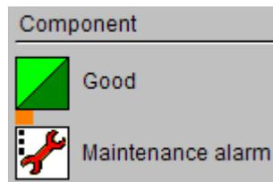
冗余组件的状态显示（维护状态）由冗余组件 A 和 B 生成。下表列出了根据此规则生成显示的图标。
