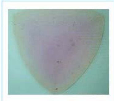
(圖三) 經深度擴散處理橘黃色藍寶石浸在二碘甲烷液中內部呈粉紅色
