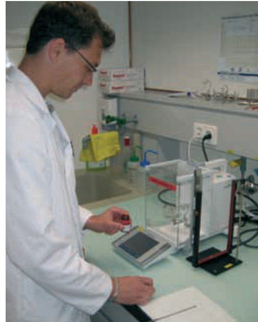
犯罪技术人员 Ivan Schlatter 在使用超越系列半微量天平 XP205 进行称量。
