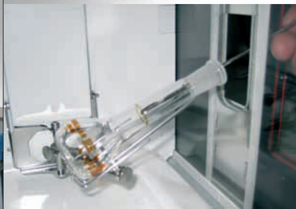
ErgoClip 容量瓶易巧称量组件和最小称量防风门。
