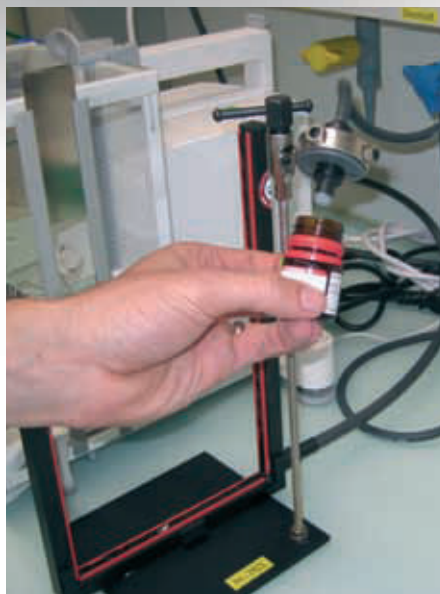
梅特勒-托利多的众多防静电解决方案之一：外置 U 形电极和点电极。
