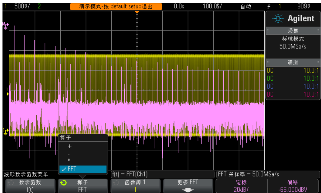
图 43 对重复数字时钟执行 FFT 数学函数
