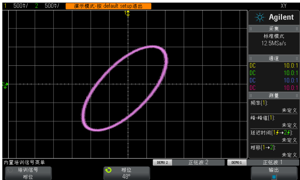
图 40 一种 Lissajous 样式, 使用示波器中相同频率的两条正弦波的 XY 模式, 但彼此超出相位 48 度
