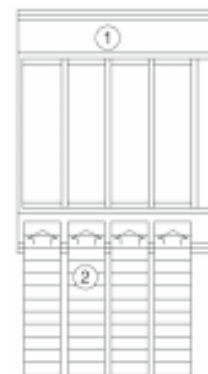
(1) 标签固定器TA523 (2) 标签滑片被插入到固定器中
