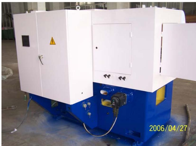
图 3 3MK205 数控轴承磨床
