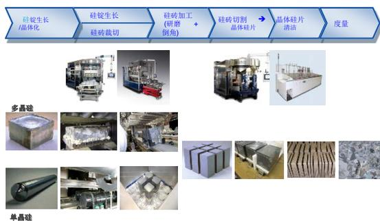
图 1: 晶体硅太阳能光伏硅片切割价值链
