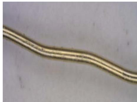
图5: 结构化切割线
