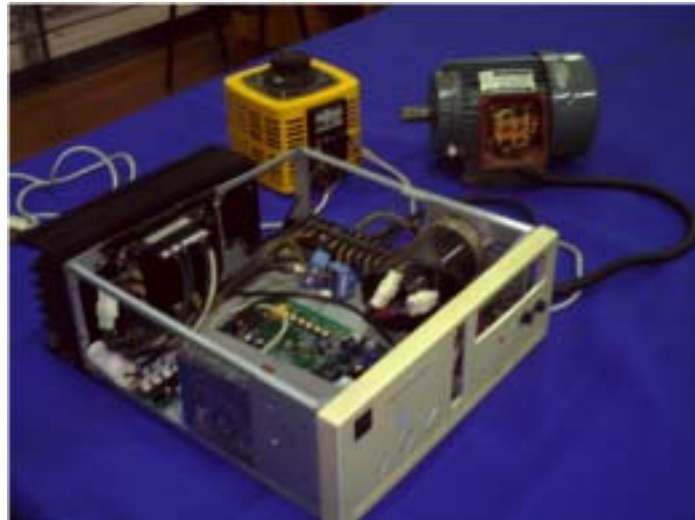
图 6.10 电机调试平台
