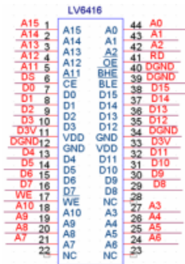
图 4.3 DSP 扩展存储器接口电路
