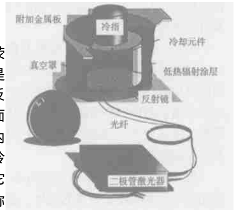
图11 新颖的固体荧光制冷器方案
