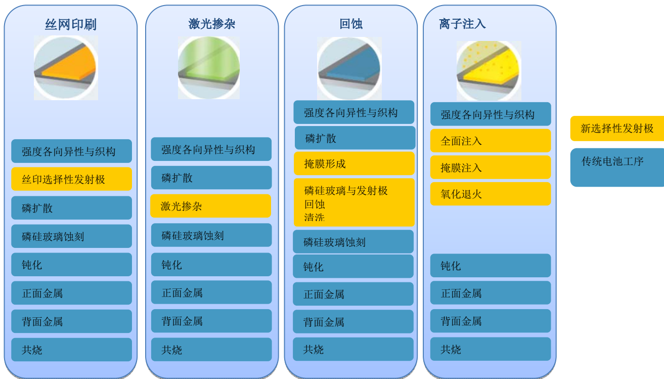
图 3：选择性发射极制作方法
