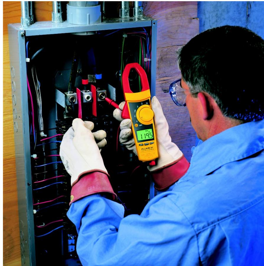
只要电路上存在电子负载（计算机、电视、照明装置、电机驱动器等），平均响应仪表的测量结果就可能不准确。电子负载越大，不准确性也越大。真有效值钳型表总能给出准确结果（当然，假设您使它保持得到校准）。因此，除非您可以放心地说不会遇到这种类型的负载，您就要使用一个真有效值钳型表。这样，您要考虑的是要进行的工作，而不是测试工具本身。
