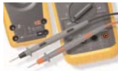
查看测试线和多用表的安全等级和电压额定值。
