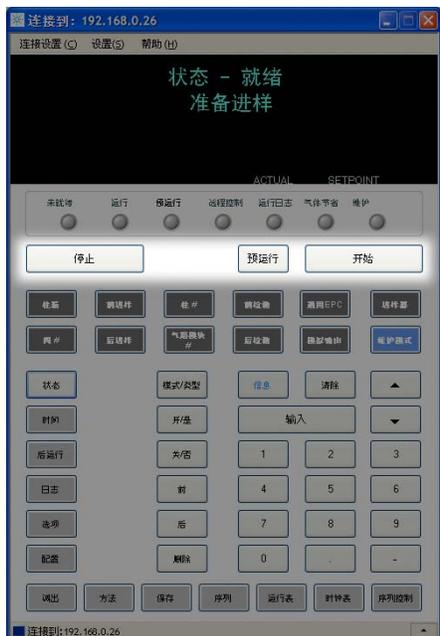
**[Prep Run]** (准备运行) 激活所需进程，使 GC 进入相应方法（如关闭不分流进样的进样口吹扫流量或从载气节省模式恢复正常流量）所述的启动状态。有关详细信息，请参阅《GC 高级用户指南》。
