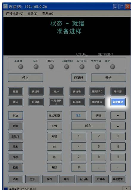
**[Service Mode]** (服务模式) 通过此键可以使用 GC 的维护功能和设置、服务计数器以及诊断功能。有关详细信息，请参阅《GC 高级用户指南》。
