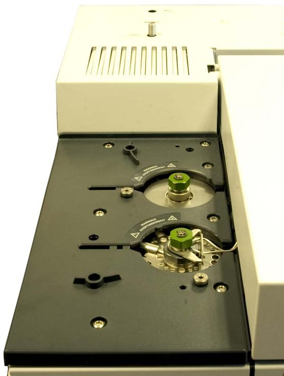
可以使用进样针手动将样品注射到进样口，或使用自动化取样设备（例如 Agilent 自动液体进样器）。
