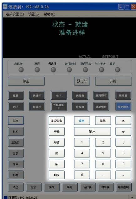
**[Mode/Type]** (模式/类型) 访问同样组件非数字设置相关联的可能参数列表。例如，若 GC 配置了分流 / 不分流进样口且按下了 **[Mode/Type]** (模式 / 类型) 键，则所列选项将为分流、不分流、脉冲分流或脉冲不分流。
