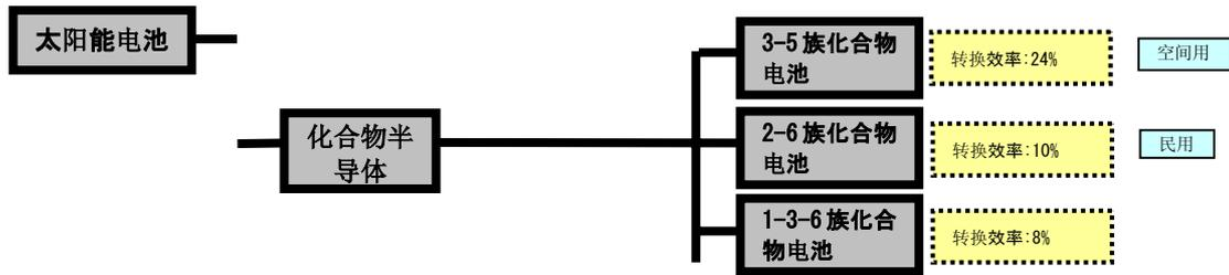
※在现在的太阳能电池产品中,以硅半导体材料为主,其中又以单晶硅和多晶硅为代表.由于其原材料的广泛性,较高的转换效率和可靠性,被市场广泛接受.非晶硅在民用产品上也有广泛的应用(如电子手表,计算器等),但是它的稳定性和转换效率劣于结晶类半导体材料.化合物太阳能电池由于其材料的稀有性和部分材料具有公害,现阶段未被市场广泛采用.
