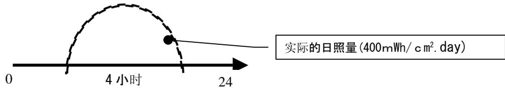
假设, PV 的容量按平均消费电力来设置的话, 系统只能带动负荷 4 个小时的运作. 为了保证其他 20 小时的负荷使用, PV 的容量的设置必须放大. 其放大倍率为  $(100 \times 24) / (100 \times 4)$ . 故公式(2)的右边为  $2400/Q'$  min.
