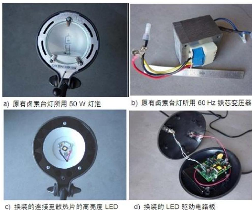
图 4：原 50 W 卤素台灯、所用变压器及改造后所用的 LED 及驱动电路板。
