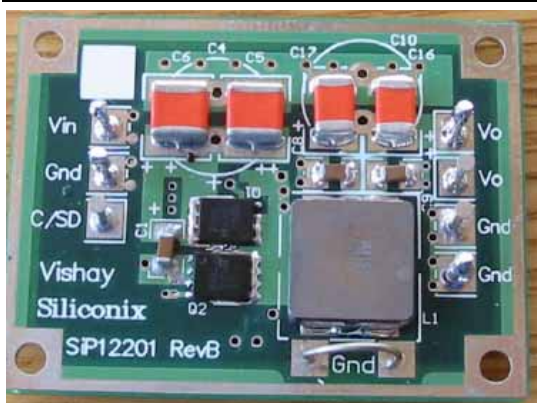
图 1：用于分析的 DC/DC 降压转换器，其中采用了 Vishay Siliconix 的 Si7392DP 和 Si7892BDP 功率 MOSFET。
