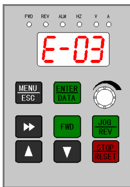
图 3—5 故障告警显示状态
