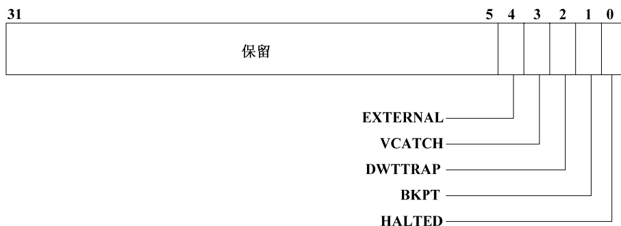
图 8-20 调试故障状态寄存器的位分配
