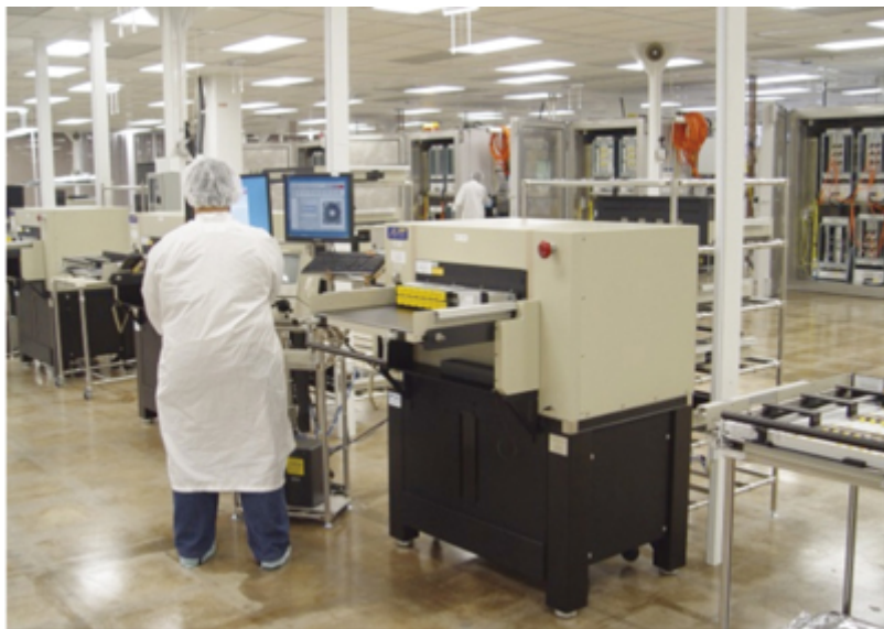
照片 3：清洁室中的自动光纤检测系统。
