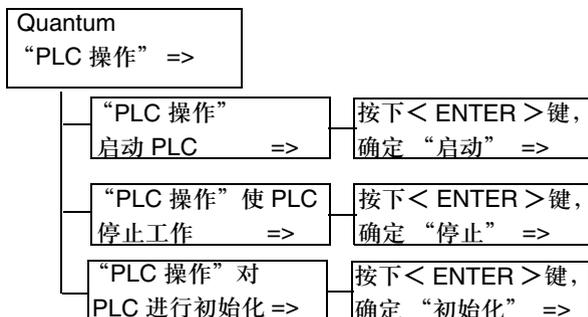
“PLC 操作”子菜单：“Start ( 启动 )”、“Stop ( 停止 )”、“Init ( 初始化 )”
