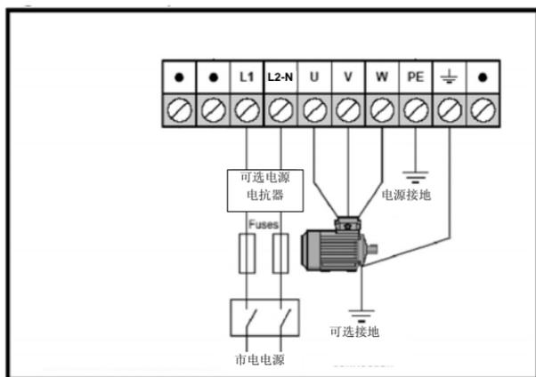
图 3-6 EV800 变频器功率端子典型连线 (SIZE-A)
