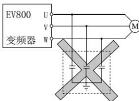
图 1-1 变频器输出端禁止使用电容器
