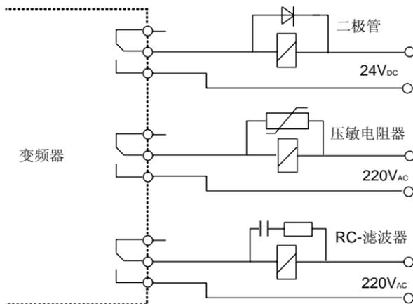
图 3-4 继电器、接触器及电磁制动器要求
