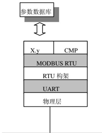
附图 5 现场总线协议结构图
