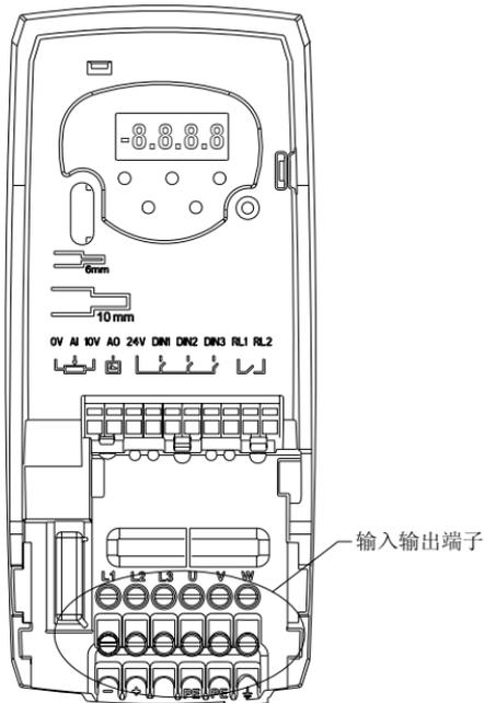
图 3-5 变频器上的各部件（以 SIZE-B 型为例）
