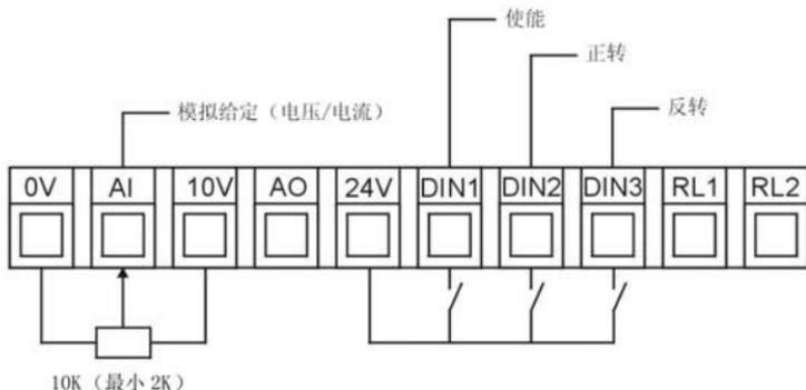
图 5-1 必需的最少控制端子连线
