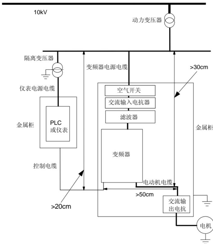
图 3-3 变频器的安装示意图
