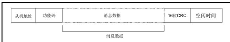
附图 6 RTU 构架的基本格式
