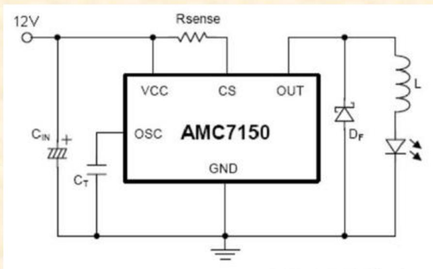
在设计参数要求不高的低压 4-25V 产品中可以选择它，基本驱动能力在 3W 以下应用设计。比如 1W 串 3 颗或 3W 1 颗 LED 设计是稳定的。
