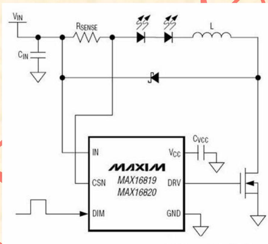
MAX16819/MAX16820 非常适合需要宽输入电压范围的应用。高边电流检测和内置电流设置电路可使外部元件的数量最少，并可提供  $\pm 5\%$  精度的 LED 电流。在负载切换和 PWM 亮度调节过程中，滞回控制算法保证了优异的输入电源抑制和快速响应。MAX16819 具有 30% 的电感纹波电流，而 MAX16820 具有 10% 的纹波电流。这些器件可工作于高达 2MHz 的开关频率，从而允许使用小型元件。
