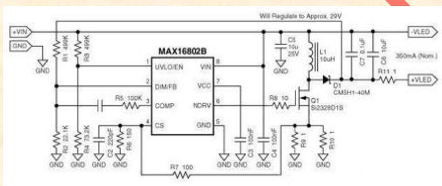
MAX16802A/B 是高亮度 (HB) LED 驱动器控制 IC，内部包含了设计一个宽输入范围 LED 驱动器所需的全部电路，适合通用照明和显示应用。适用于低输入电压 (10.8V DC 至 24V DC) LED 驱动器。需要精密调节 LED 电流时，可利用片上的误差放大器以及精度为 1% 的基准。通过低频 PWM 亮度调节可实现较宽的亮度调节范围。
