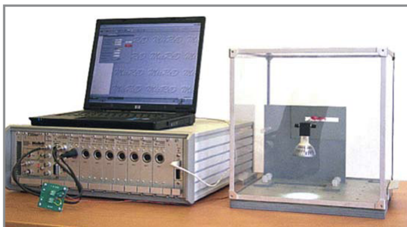
图 3 使用 Tr3ster 对改进的 MR16 进行测试
