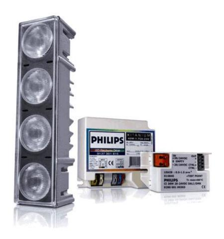
备注: Philips 公司的彩色动态式 LED 照明模块,四组灯泡内各有一个 1W 的高亮度、高功率 LED, 且分别是红、绿、蓝、琥珀等四种颜色,主要用于购物场所的气氛照明、墙壁色调的改变、建筑物的户 外特效照明等。
