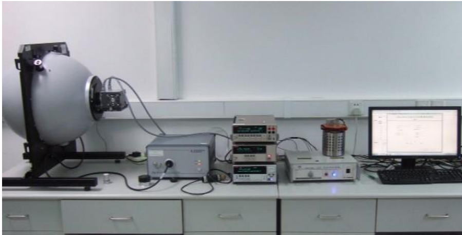
图 1: LED 结温测量及利用 V_f-T_J 曲线在设定结温条件下的光、色、电参数测量系统
