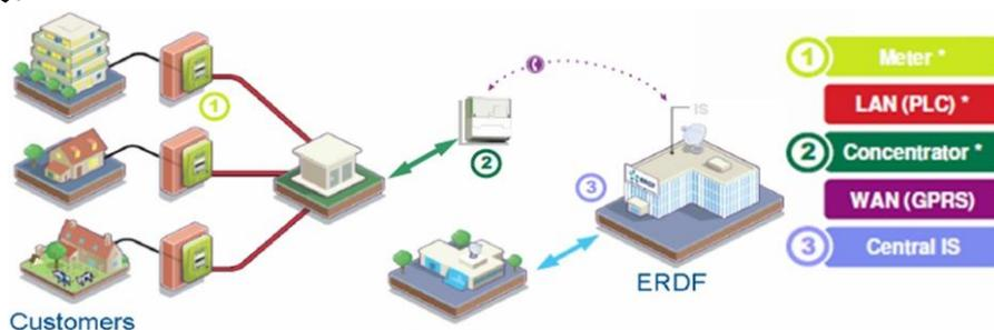
图 1：法国 EDF 旗下公司法国配电公司(ERDF)的 Linky 项目简略示意图
