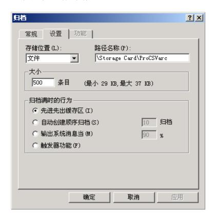
在"归档满时特性"中的标准设置"先进先出缓冲区",可使归档填满时覆盖最早的数据。
