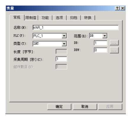
每个变量具有一个符号名以及已定义的数据类型。变量值随着控制程序的进展而改变。与 PLC 链接的变量称为全局变量。不与 PLC 链接的变量称为局部变量。
