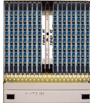
7342 ISAM FTTU 具有高达 1T 的交换能力，完全能够实现无阻塞线形交换，每单板能够提供 8 个 EPON 端口，一个子框支持 14 个线卡，共计 112 个 EPON 用户接口。
