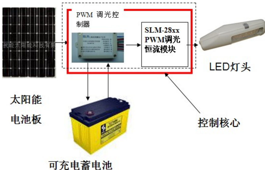
图 1. 太阳能路灯的构成
